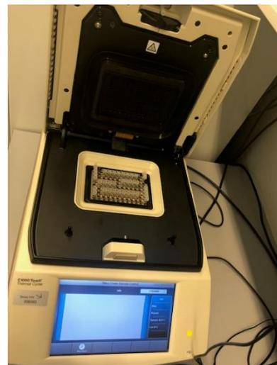
Abbildung 2.8: Thermocycler, in welcher die DNA-Proben für die PCR amplifiziert werden
